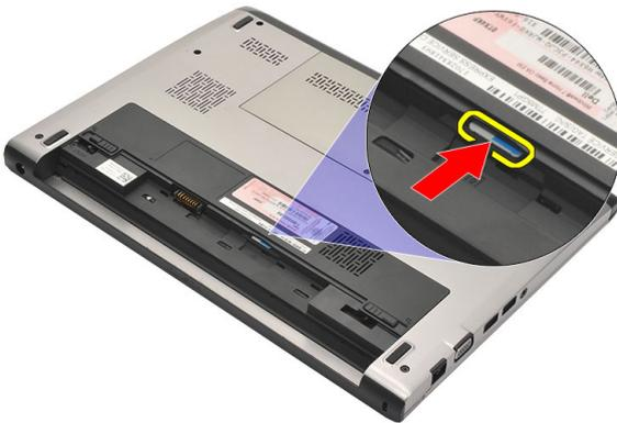
4. Greifen Sie die SIM-Karte und ziehen Sie sie heraus, damit sie aus dem Computer herauspringt.
