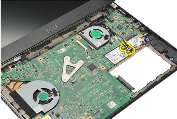
8. Entfernen Sie die Schraube, mit der die WWAN-Karte an der Systemplatine befestigt ist.
