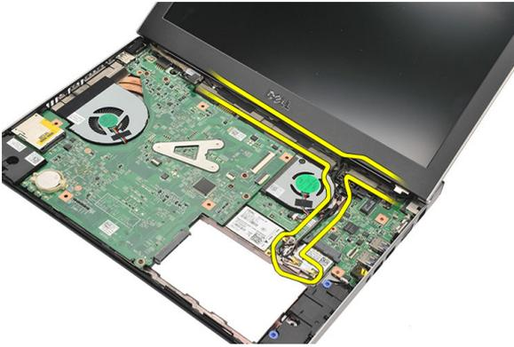
9. Trennen Sie das Bildschirmkabel vom Computer und lösen Sie es aus der Kabelführung.
