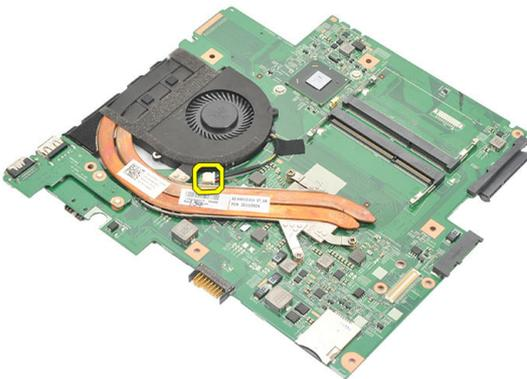
15. Lösen Sie die unverlierbaren Schrauben, mit denen der Kühlkörper an der Systemplatine befestigt ist.
