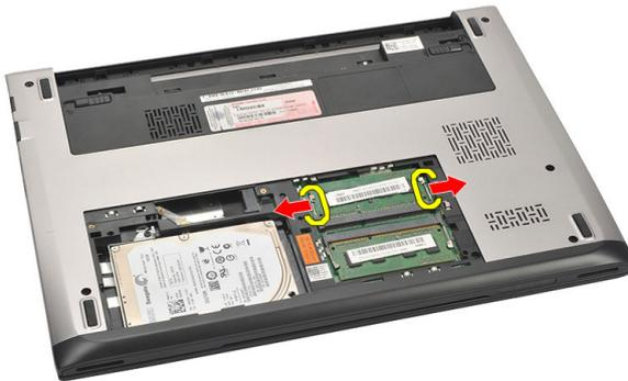
5. Entfernen Sie das Speichermodul aus dem Computer.
