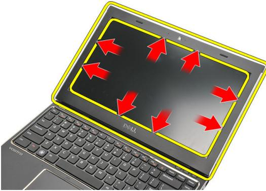
4. Heben Sie die Bildschirmblende an und entfernen Sie sie aus der Bildschirmbaugruppe.
