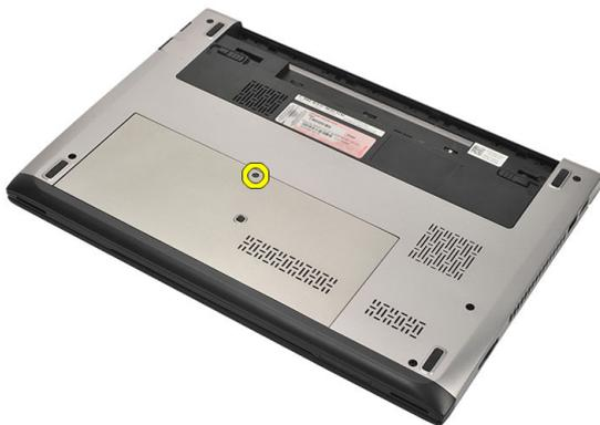
4. Schieben Sie die Abdeckung an der Unterseite in Richtung der Computerrückseite. Heben Sie sie aus dem Computer heraus.
