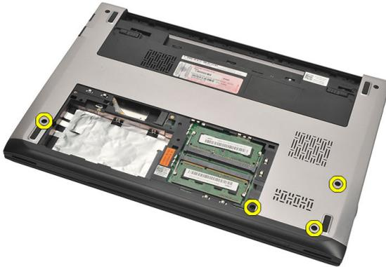
7. Entfernen Sie die Schrauben an der Handballenstütze.
