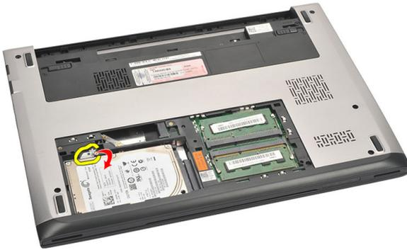
7. Entfernen Sie die Schrauben, mit der die Festplattenlaufwerkhalterung an der Festplatte befestigt ist. Trennen Sie die Festplattenlaufwerkhalterung von der Festplatte.
