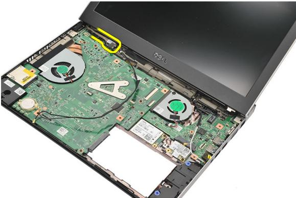
10. Entfernen Sie die Schraube, mit der das rechte Scharnier befestigt ist.
