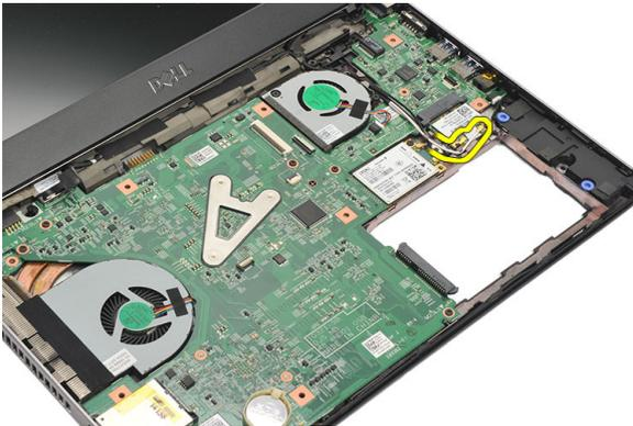
8. Entfernen Sie die Schraube, mit der die WLAN-Karte an der Systemplatine befestigt ist.
