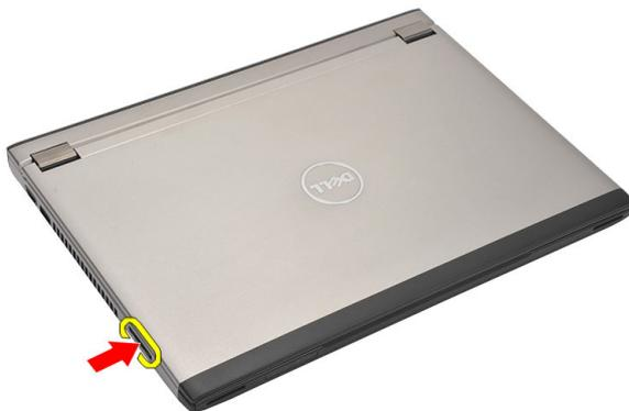
3. Greifen Sie die SD-Karte und ziehen Sie sie heraus, damit sie aus dem Computer herauspringt.
