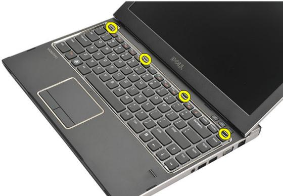
4. Schwenken Sie die Tastatur nach vorn und legen Sie sie auf der Handballenstütze ab.
