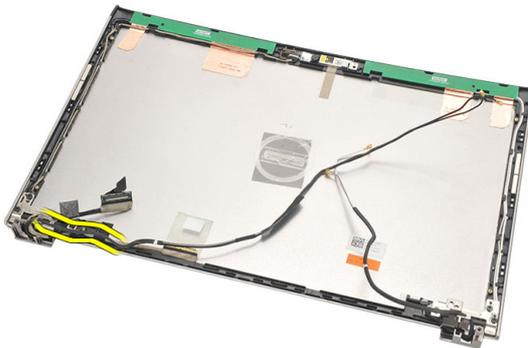
11. Entfernen Sie das LVDS-Kabel (Low Voltage Differential Signaling) vom linken Bildschirmscharnier.
