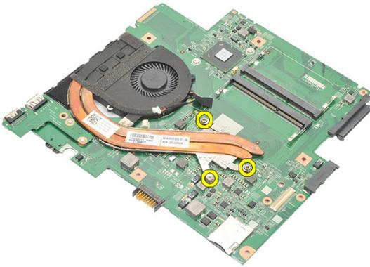
**16.** Heben Sie den Kühlkörper hoch und entfernen Sie ihn von der Systemplatine.
