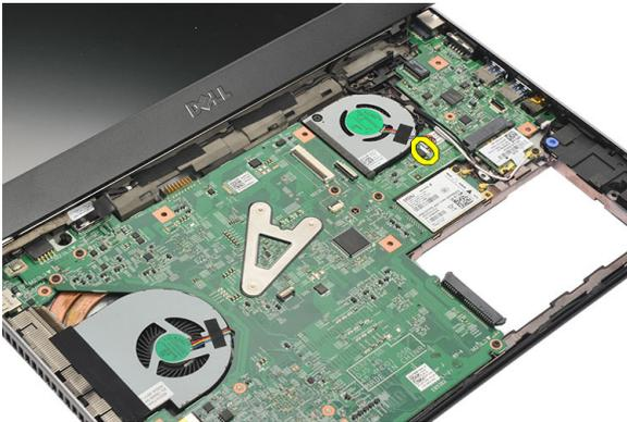
8. Entfernen Sie die Schrauben, mit denen der Lüfter am Computer befestigt ist.
