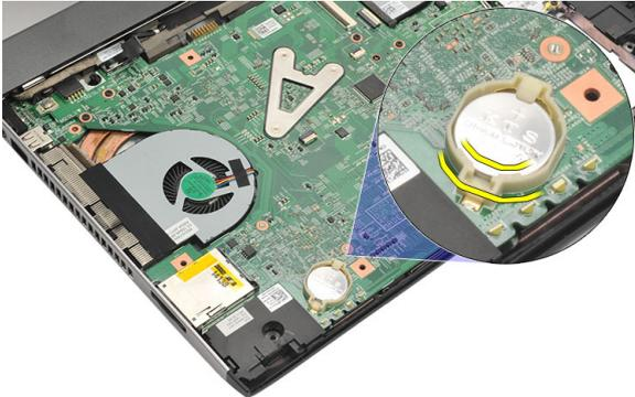
8. Entfernen Sie die Knopfzellenbatterie aus dem Computer.
