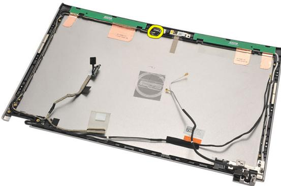
11. Lösen Sie das LVDS-Kabel aus seiner Halterung und entfernen Sie es von der oberen Bildschirmabdeckung.
