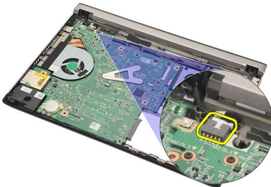
14. Entfernen Sie die Schraube, mit denen der DC-In-Anschluss befestigt ist.
