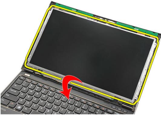
12. Ziehen Sie das Klebeband ab, mit dem die LVDS (Low-Voltage Differential Signalling)-Verbindung am Bildschirm angebracht ist.
