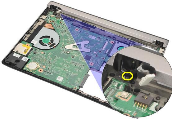
15. Heben Sie den DC-In-Anschluss an und entfernen Sie ihn von der Unterseite des Gehäuses.
