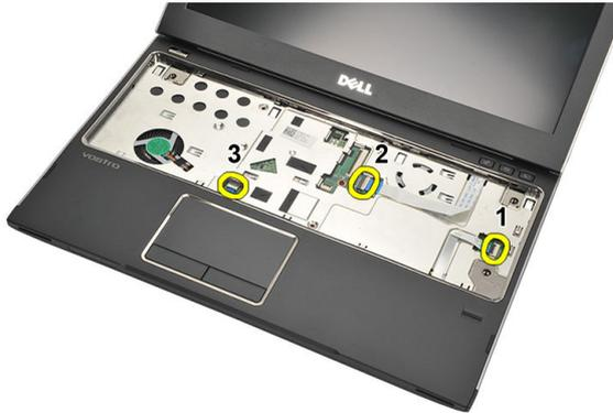
9. Hebeln Sie die äußeren Enden der Handballenstützen-Baugruppe vorsichtig mit einem Kunststoff-Stift heraus, und entfernen Sie die Handballenstützen vom Computer.
